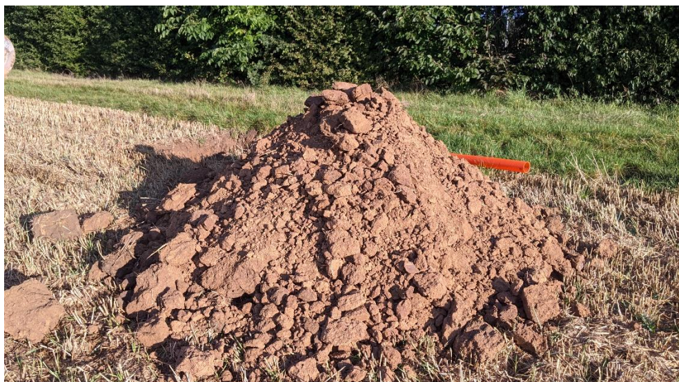
Bild 6: Baggeraushub aus Schurf S1.
