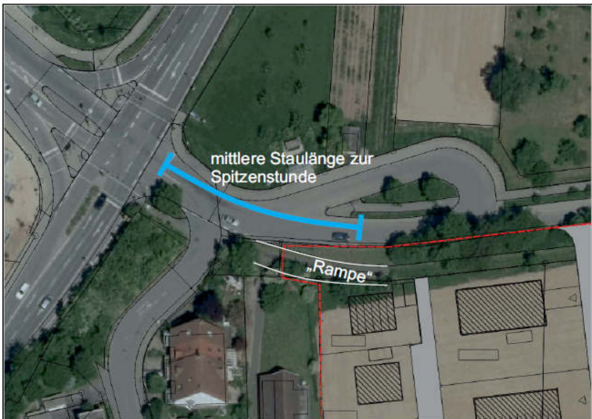
Abbildung 7: Ausschnitt nördliche Anbindung des Plangebiets über eine bestehende „Rampe“
