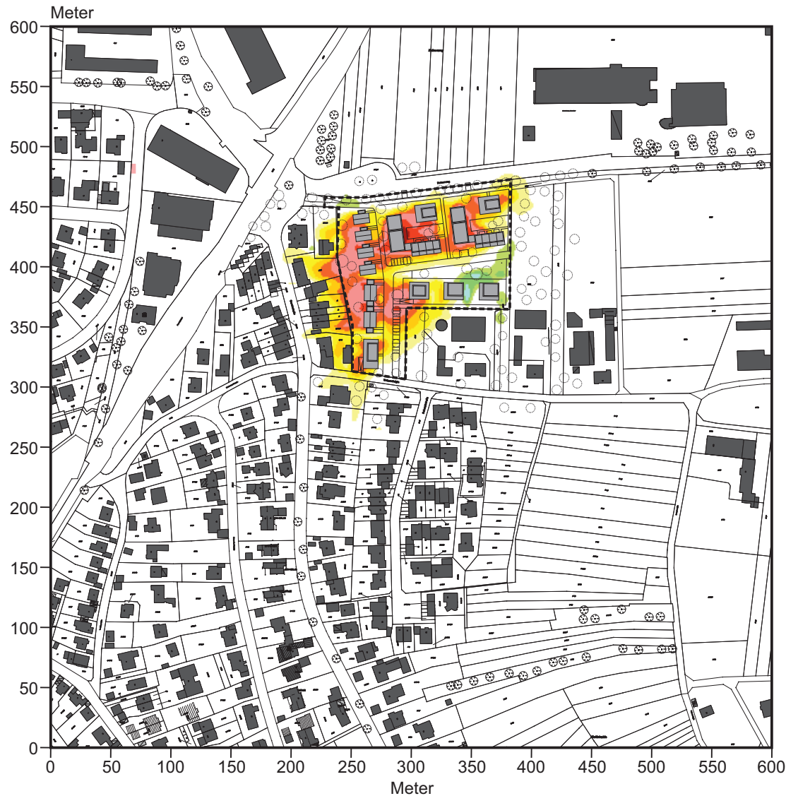
Abb. 15.3 Vorher-Nachher-Vergleich / Ergebnisse von Windfeldsimulationen Planungsbedingte Veränderung der Windgeschwindigkeiten 2 m ü.G. (Tagsituation). Windanströmung aus Nordosten (60°) mit 2.5 m/s in einer Höhe von 10 m ü.G.
