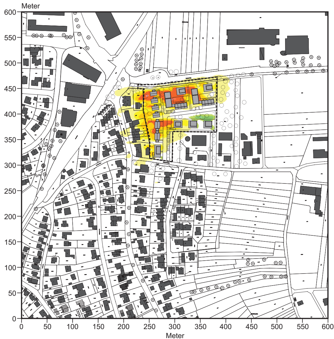
Abb. 16.3 Vorher-Nachher-Vergleich / Ergebnisse von Windfeldsimulationen Planungsbedingte Veränderung der Windgeschwindigkeiten 2 m ü.G. (Nachtsituation). Windanströmung aus Osten (80°) mit 2.0 m/s in einer Höhe von 10 m ü.G.
